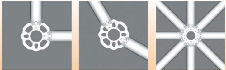
Un système de rosaces comportant quatre fentes étroites et quatre fentes larges permet à l'échafaudage METRIX PLETTAC d'être vraiment omnidirectionnel ! Huit barres, lisses, diagonales ou consoles peuvent être connectées sur une même rosace.
